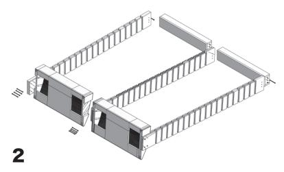
ステージを起こして袖パネルを差込み、ボルトナット(共通)で、ステージの裏から連結します。遊びの無いように締めて下さい。終わりましたら、ルーバーに同じようにダボを差込み、ボルトナットで連結して下さい。
