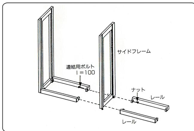
③ 単体、又は連結する場合の最後は、下側レールにサイドフレームをエンド用ボルトで取付けます。
