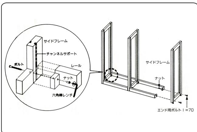
④ 単体、又は必要連結分サイドフレームと下側のレールが組み終わったら上側のレールを①～③の順番で同様に取付けます。この時レールの向きに注意してください。
