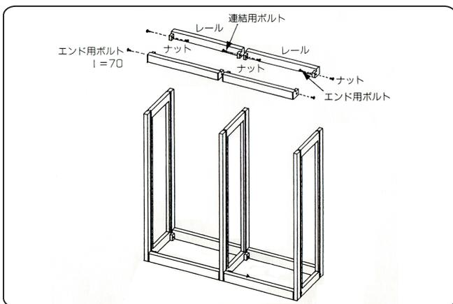
⑤ 上下棚を上下レールに落とし込みます。棚板の間隔を決めて柱に埋め込まれているスチールのサポート柱に棚受けダボを差し込んで下さい。
