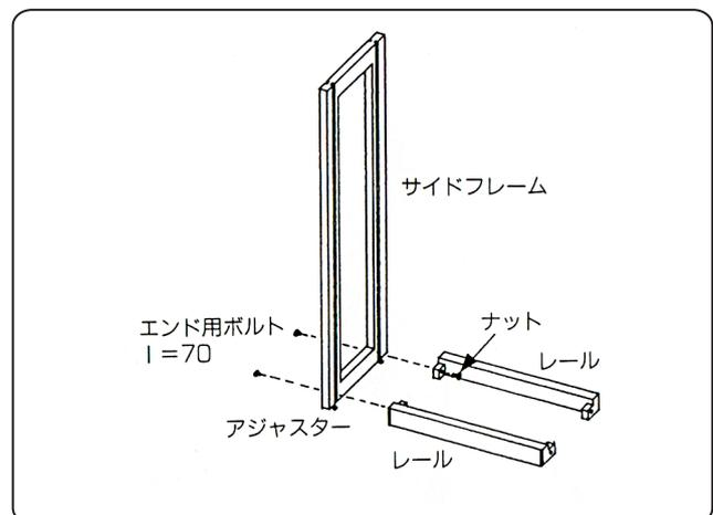
② 連結する場合、レール2本でサイドフレームをはさむようにして連結用ボルト、ナットで取付けます。
